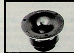
DMR 15 , HiFi-koepelmembranluidspreker 60/100W, 450-15000 Hz, 122 mm ø. Voor inbouw vanaf voorzijde.
