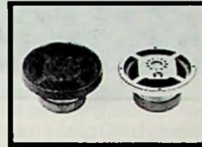
C 16-3 3-wegs auto-stereo luidspreker 'Super-sound', hoge belastbaarheid door sterke magneet. 30 watt, 45-22.000 Hz, 158 mm ø.
